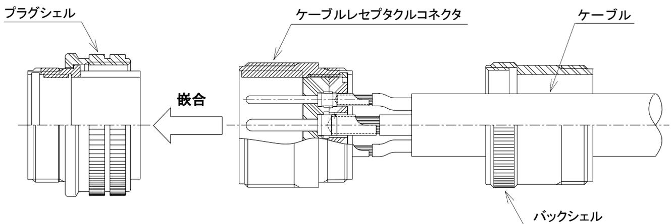
5-11. バックシェルにケーブルランプボディを締め付けます。
